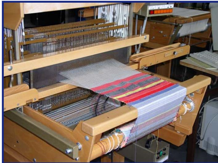
Figure 4 : Prototypes de tissu réalisés sur machine à main
